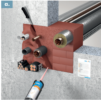
a. Protivpožarna pena – FPF iz Knauf sistema u masivnom zidu
